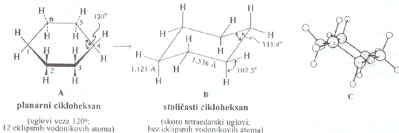
Слика 1. Претварање (А) хипотетичког планарног циклохексана у столицасту конформацију; (В) дужине веза и углови; (С) молекулски модел. Столичаста конформација је скоро без напона
