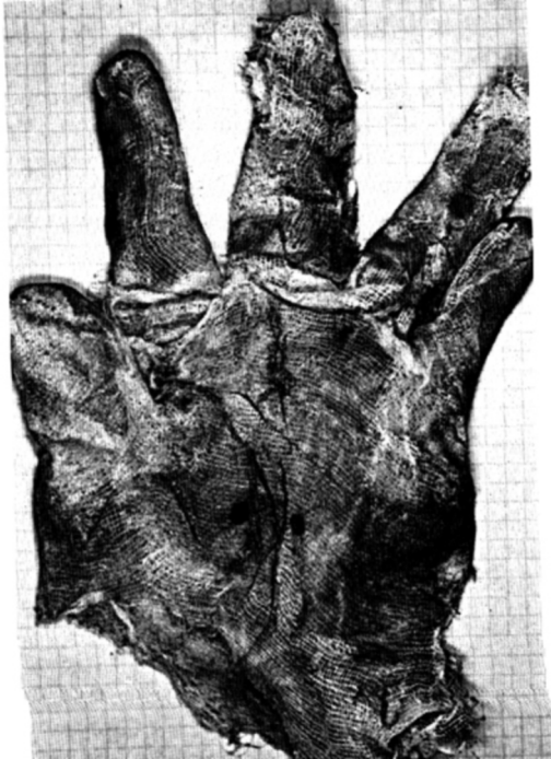
Слика 3. Рукавица начињена помоћу поливинилалкохола (ПВАЛ), са траговима од пуцања. Између ње и парафинске рукавице нема битне разлике.
