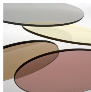
Слика 2. Фото-осетљива стакла различите боје након интеракције са УВ зрацима.
